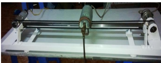
Hình 1. Mô hình thực nghiệm cân bằng con lắc ngược dùng bộ điều khiển cuộn chiếu
